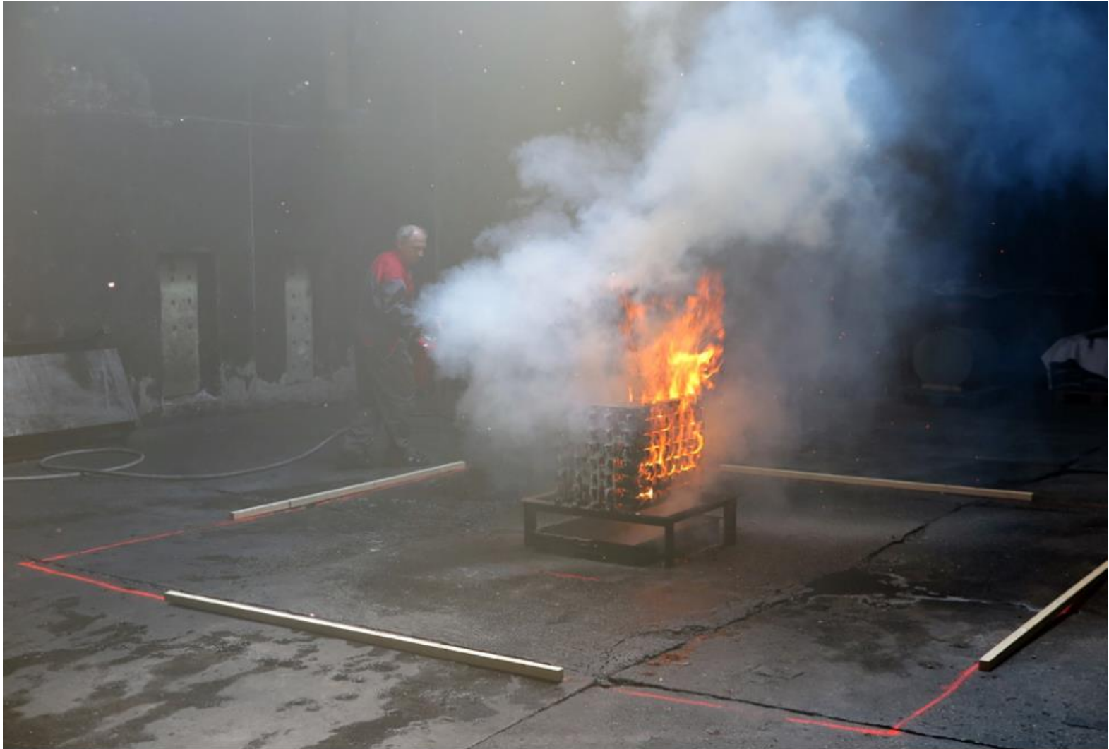
Ein Praxistest: Ablöschen des Prüfobjekts 21 A gemäß DIN EN 3-7 (Bild: Peter Gundermann)
