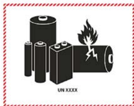
Kennzeichnung für Li-Batterien (SV 188)
