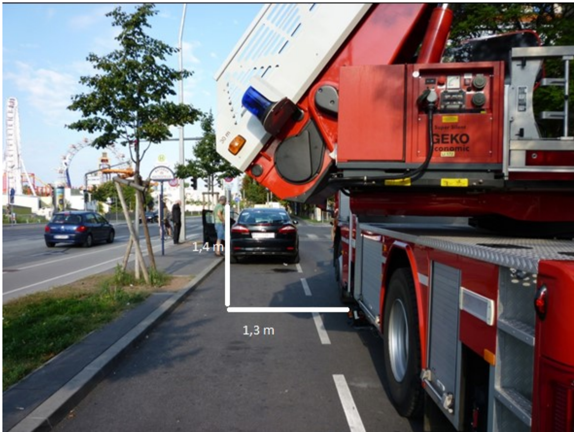
Abb. 6: Schwenkbereich der Drehleiter
